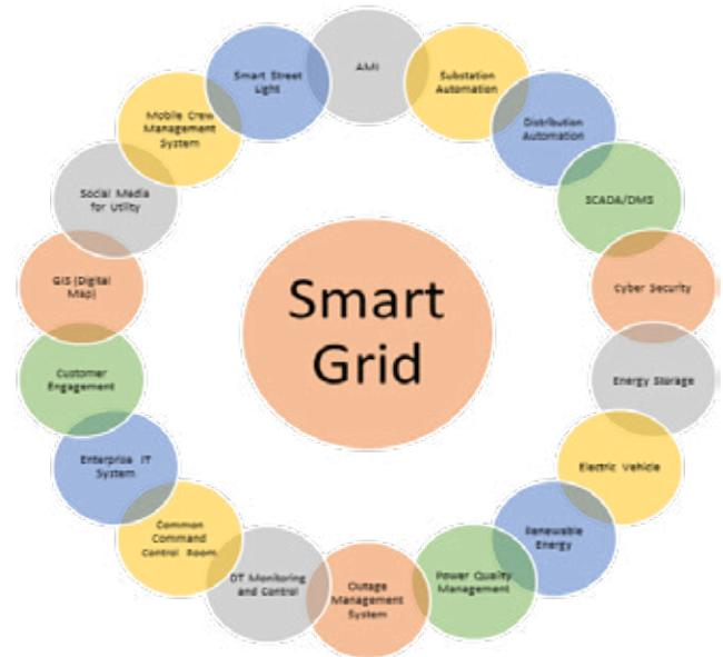
Fig. 1 : Smart Grid Components
